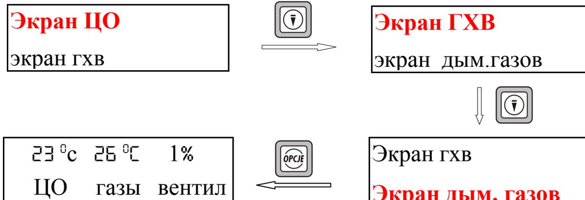
С левой стороны дисплея указана темпер. котла; по середине дисплея - температура выхода дымовых газов и справа стороны дисплея - мощность вентилятора. Чтобы вернуться в главное меню следует нажать клавиш .
