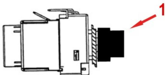
**ВНИМАНИЕ:** В случае повреждения «термика» вентилятор не действует как в работе вручную так и в автоматической.
