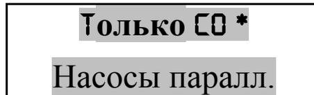
Выбирая этот опцион регулятор переходит в состояние отопления только дома. Насос СО начинает работать выше температуры включения насосов (заводская установка на 35°C ), смотри п. **II d** . Ниже этой температуры (минус 3°C) насос перестает работать.
