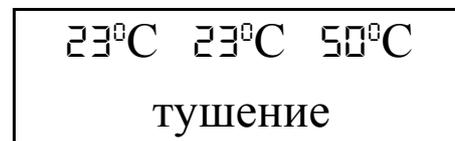
В этом режиме работа насосов начинается параллельно выше температуры включения насосов (заводская установка на 35°C). Но эти температуры могут быть разными, в зависимости от их установки клиентом. Приводит это к неодновременному включению насосов, но, после превышения обоих этих порогов насосы будут работать вместе (параллельно). Насос СО (центрального отопления) работает все время, а насос ГХВ (горячей хозяйственной воды) выключается после достижения заданной на бойлере температуры.
